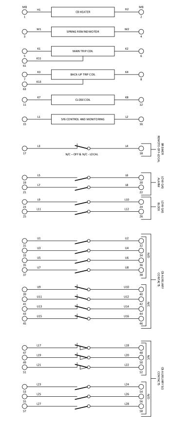
NOTE: ALL BREAKER CONTACTS TO BE SHOWN FOR THE BREAKER IN THE OPEN POSITION, THE SPRING DISCHARGED, THE BREAKER REMOTE-OFF-LO CAL SWITCH IN THE OFF POSITION AND NO GAS (IF APPLICABLE). ALL RELAYS TO BE SHOWN IN THE DE-ENERGISED POSITION.
